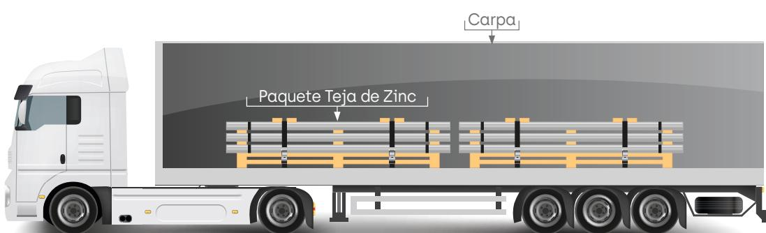
Cuando se transporten paquetes de Teja de Zinc se deben zunchar para evitar vibración y desplazamiento una sobre otras. Los paquetes deben estar debidamente asegurados para evitar desplazamiento de cargas.
